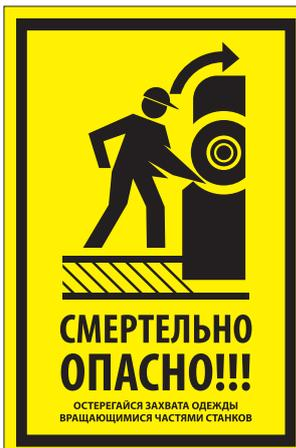
VS 21-02 Смертельно опасно! Остерегайся захвата одежды вращающимися частями станков
